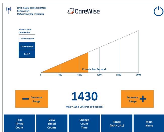
Abbildung 21a – Main Count Screen (Hauptanzeige-Bildschirm) mit dem Drahtlos-Symbol für den Betriebsmodus mit aktivem drahtlosen Apollo Handgerät
