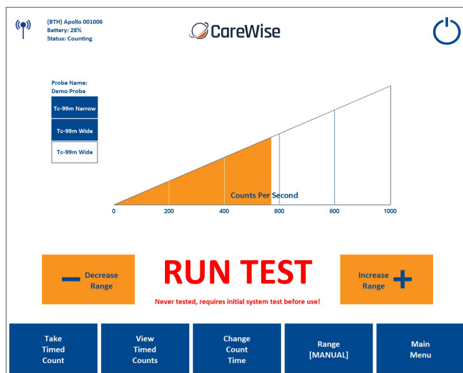
Abbildung 12c – „Main Counts Screen“ (Hauptanzeigebildschirm) mit dem Hinweis zur Durchführung eines Systemtests, wenn ein neues OmniProbe oder Apollo Handgerät ausgewählt wurde, bei dem noch nie ein Systemtest durchgeführt wurde
