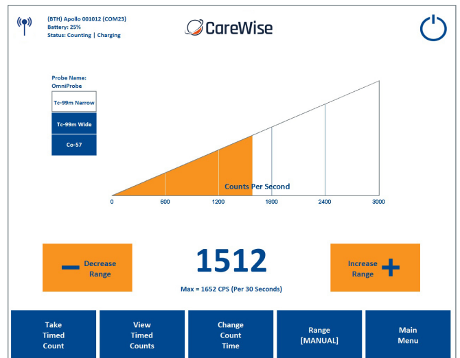
Abbildung 27 – „Main Counts Screen“ (Hauptanzeige-Bildschirm) mit den zusammenfassenden Informationen zum angeschlossenen Gerät
