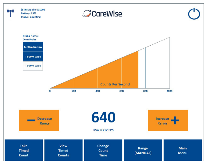
Abbildung 29 – „Main Counts Screen“ (Hauptanzeige-Bildschirm) mit dem Hinweis, dass das Apollo Handgerät aus dem Energiesparmodus reaktiviert wurde.
