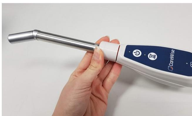
Il manipolo Apollo e OmniProbe possono ora essere accesi premendo il pulsante di accensione situato sulla tastiera Apollo. Il LED superiore lampeggia in blu fino a quando il manipolo non viene collegato al software Apollo (vedere la Sezione 2.4-14). Una volta effettuato il collegamento, il LED superiore si illumina con una luce blu fissa:
