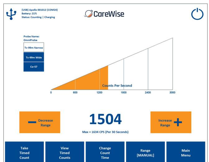
Figura 21b – Schermata di conteggio principale che mostra l'icona USB per la modalità operativa attiva del manipolo Apollo cablato
