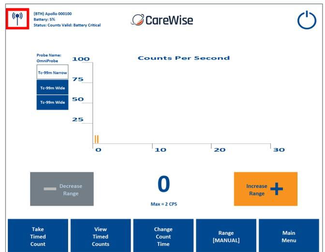
Figura 36 – Indicazioni di batteria scarica
