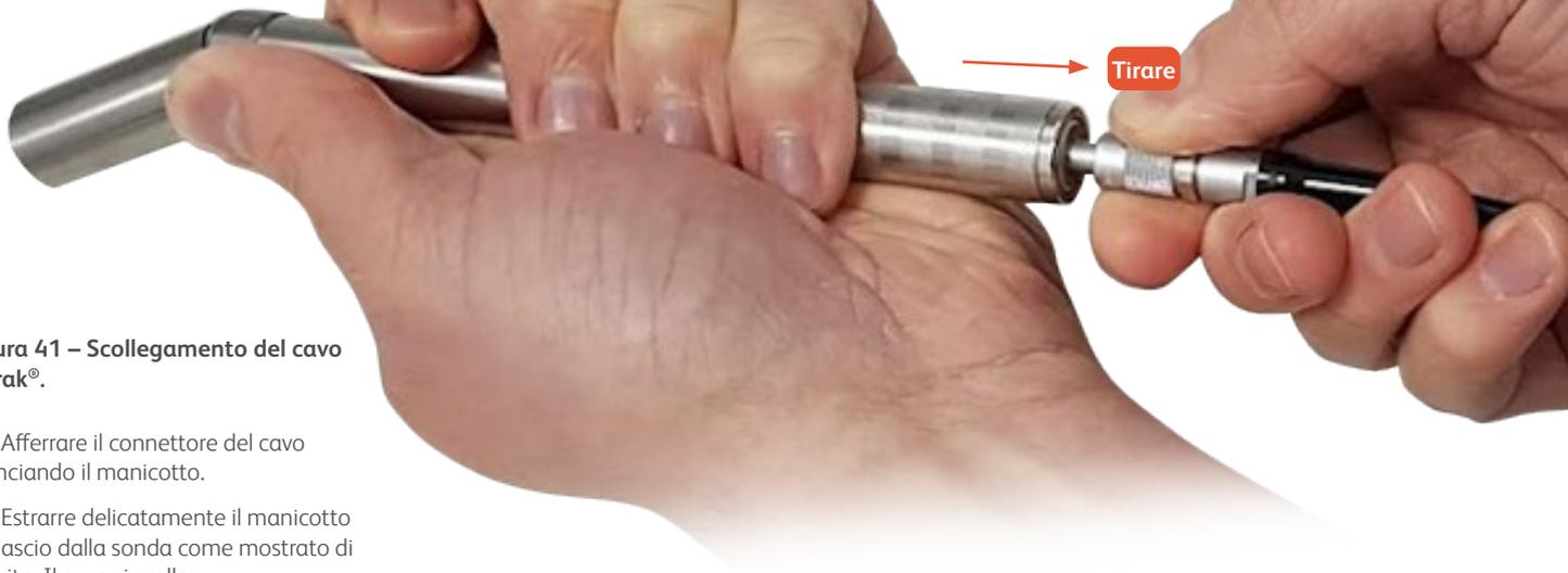
**Figura 41 – Scollegamento del cavo C-Trak®.**
