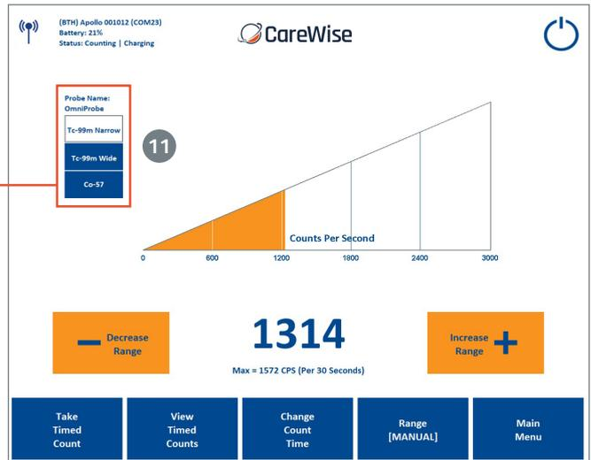
Figura 4 (duplicata da pagina 8) – Schermata conteggio con misuratore a cuneo e finestra informazioni chirurgiche evidenziata (Informazioni sonda e Impostazioni finestra isotopi) (se la sonda non è stata calibrata negli ultimi 30 giorni, verrà richiesta la calibrazione).
