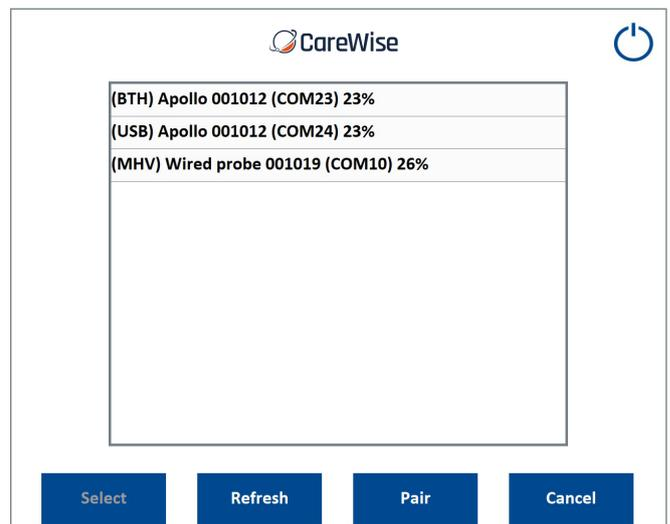
Figura 22a – Per associare un nuovo manipolo tramite wireless, è necessario premere il pulsante Pair (Associa)
