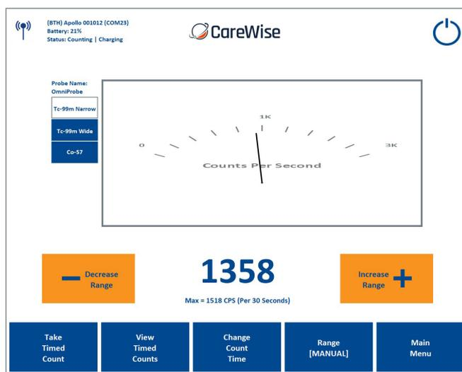
Figura 5 – Schermata conteggio con misuratore analogico
