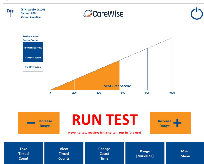
Obrázek 12c – Hlavní obrazovka počítání impulzů zobrazující indikaci pro spuštění testu systému, pokud je vybrána nová ovládací rukojeť OmniProbe nebo Apollo, u které dosud nebyl proveden test systému.
