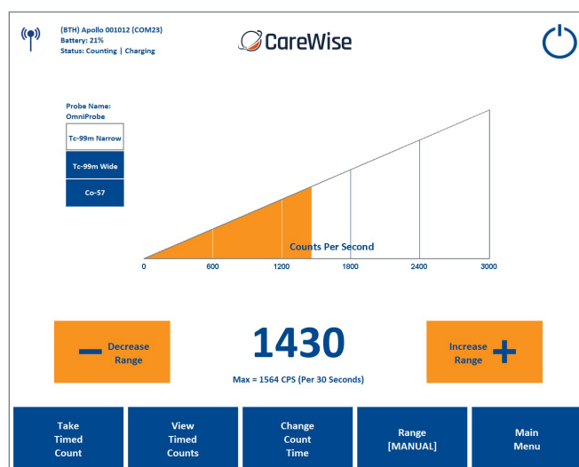
Obrázek 21a – Hlavní obrazovka počítání impulsů zobrazující ikonu bezdrátového připojení pro aktivní režim provozu bezdrátové ovládací rukojeti Apollo
