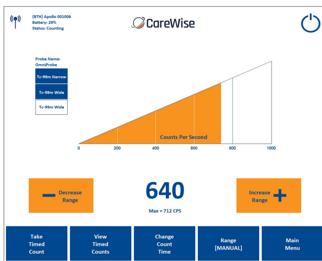
Obrázek 29 – Hlavní obrazovka počítání impulzů zobrazující, že ovládací rukojet Apollo se po době spánku stala opět aktivní.
