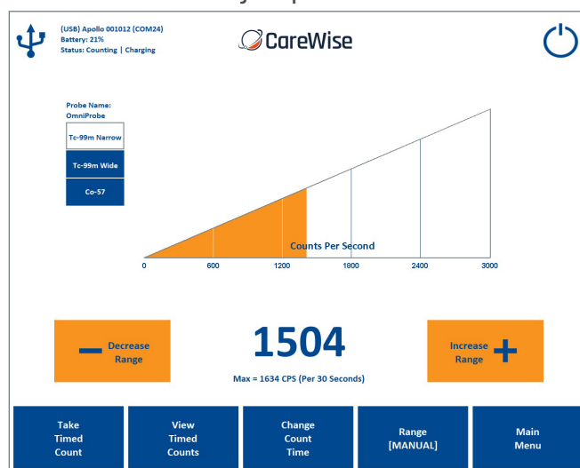
Obrázek 21b – Hlavní obrazovka počítání impulsů zobrazující ikonu USB pro aktivní režim provozu kabelové ovládací rukojeti Apollo s konektorem USB
