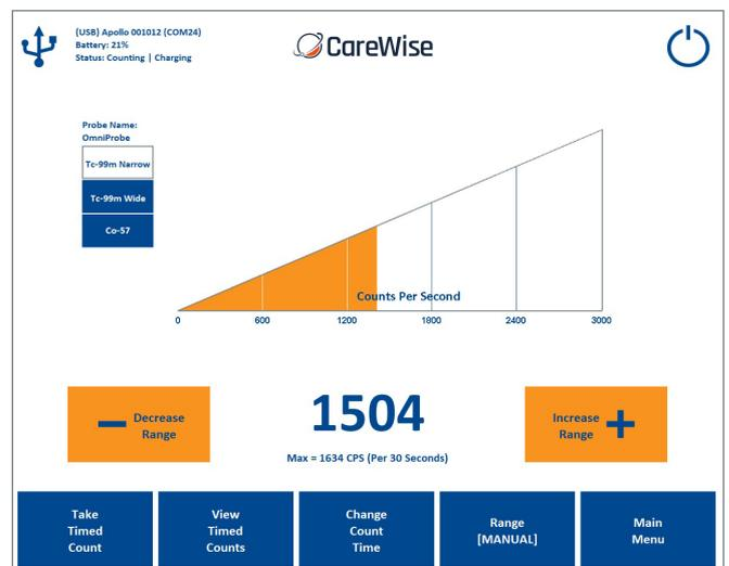
Figura 21b – Pantalla de Conteo Principal que muestra el icono USB para el modo de operación del dispositivo Apollo con cable USB activo
