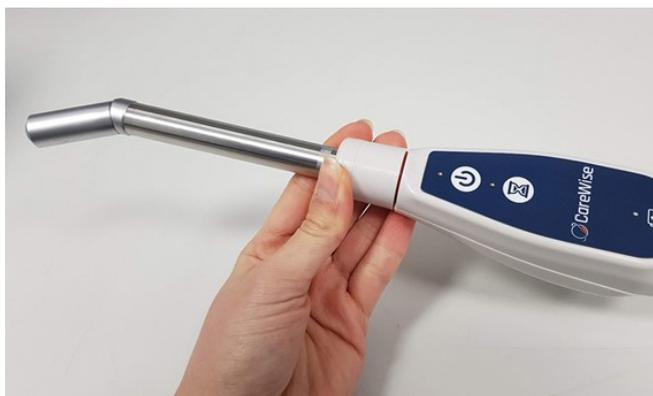
El Dispositivo Apollo y el OmniProbe ahora se pueden encender presionando el botón "Encendido" ubicado en el teclado Apollo. El LED superior parpadeará en azul hasta que el dispositivo esté conectado en el software Apollo (consulte la Sección 2.4-14). Una vez conectado, el LED superior se iluminará con una luz azul constante:
