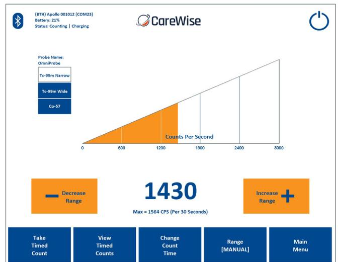
Figura 21a – Pantalla de Conteo Principal que muestra el icono inalámbrico para el modo de operación del dispositivo inalámbrico Apollo activo
