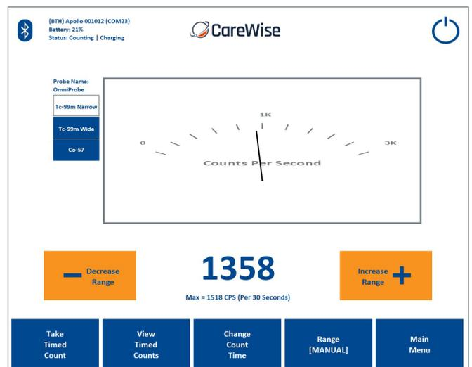
Figura 5 – Pantalla de Conteo con Medidor Analógico
